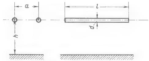
Bild 20. Paralleldrahtleitung über Erde
