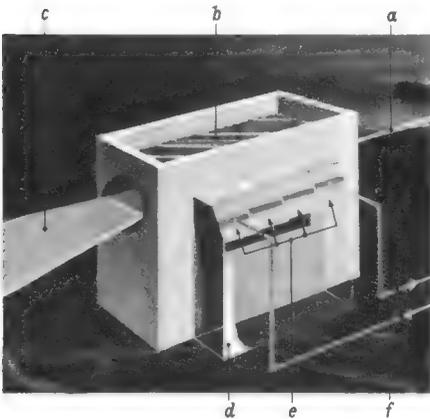
Mit Ultraschall arbeitende Ablenkeinheit für Fernseh-Großbildprojektion. Es bedeuten: a = modulierter Laserstrahl, b = Wasser, c = abgelenkter Strahl, d = Glasblock, e = Ultraschallwandler, f = Ablenkensignale. Erläuterung im Text
