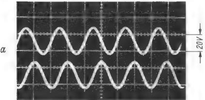
Bild 4. Farbtügersignale an den Ausgängen I und II der Schaltung für zwei aufeinander folgende Zeilen;
