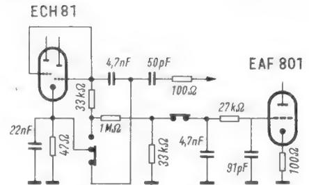
Bild 7. Regelung der Röhre ECH 81
