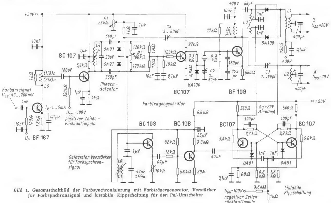
Bild 1. Gesamtschaltbild der Farbsynchronisierung mit Farbträgergenerator, Verstärker für Farbsynchronsignal und bistabile Kipperschaltung für den Pal-Umschalter
