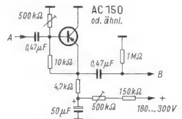
Bild 4. Schaltung eines Impedanzwandlers
