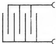
Bild 23. Plattenkondensator (n-Platten)
