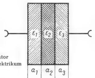
Bild 24. Kondensator mit geschichtetem Dielektrikum
