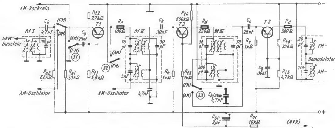
Bild 32.4. Zwischenfrequenzteil eines FM-AM-Supers mit Transistoren in Basisschaltung
