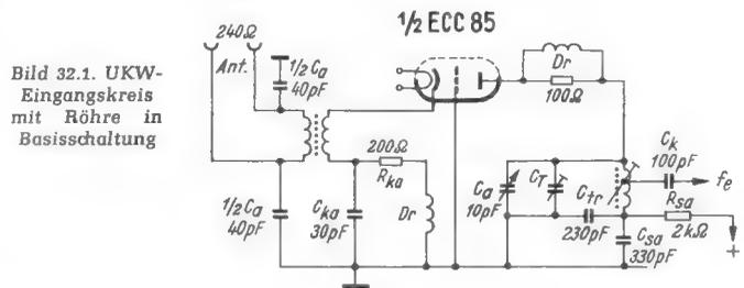
Bild 32.1. UKW-Eingangskreis mit Röhre in Basisschaltung
