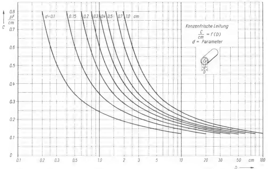
Bild 17. Kapazität/cm für die konzentrische Leitung:  $C = f(D, d)$
