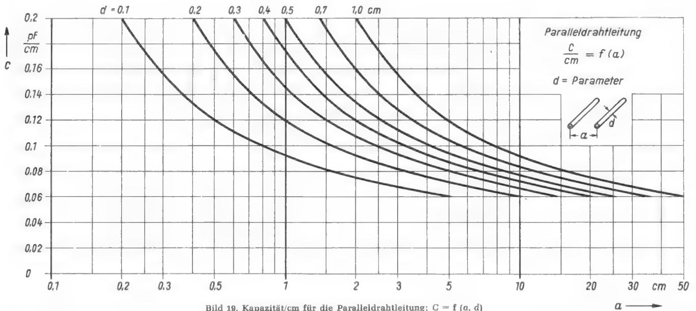
Bild 19. Kapazität/cm für die Paralleldrahtleitung;  $C = f(a, d)$
