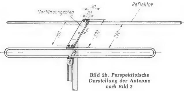
Bild 2b. Perspektivische Darstellung der Antenne nach Bild 2
