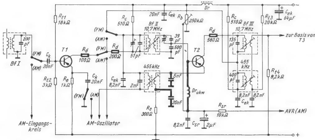
Bild 32.6. Beispiel einer elektronischen Umschaltung von Basis- auf Emitterschaltung im Zf-Verstärker
