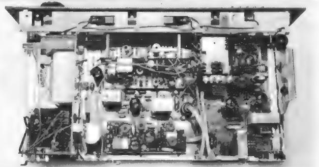
Rechts: Bild 2. Ansicht des Chassis, das gemischt mit Transistoren und Röhren bestückt ist. Rechts unten sind die Endstufen mit den Röhren ECLL 800 zu erkennen
