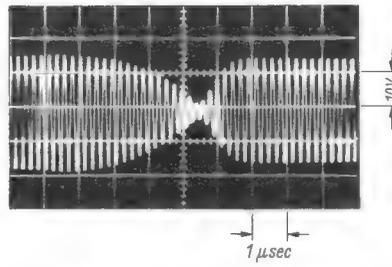
Bild 3. Umschaltung des Farbtügersignals während der Austastlücke. Der durch die Umschaltung hervorgerufene Ein- und Ausschwingvorgang dauert nur etwa 4 µsec, so daß innerhalb der Austastlücke der Endwert wieder erreicht ist
