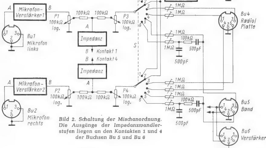
Bild 2. Schaltung der Mischanordnung. Die Ausgänge der Impedanzwandlerstufen liegen an den Kontakten 1 und 4 der Buchsen Bu 5 und Bu 6
