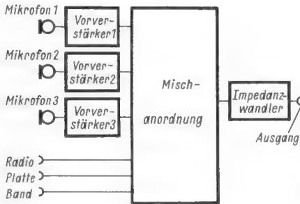
Bild 1. Blockschaltbild eines Mischpultverstärkers
