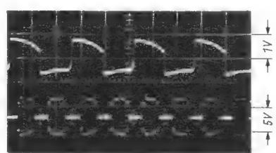
Bild 6. Pal-Impulse am Phasendetektor, wenn die Verbindung zur Basis des Transistors BC 108 aufgetrennt wird (a); Farbtügersignal am Eingang der Schaltung (b)
