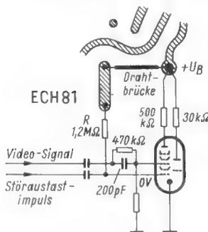
Schaltungsauszug der Impulstrennstufe mit Störaustastung. Am Gitter 1 lag eine Spannung von  $-1,2$  V statt 0 V. Als Ursache stellte sich eine Unterbrechung an der Drahtverbindung zwischen dem Widerstand R und der Betriebsspannung heraus
