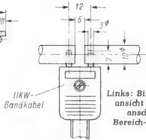
Links: Bild 2c. Seitenansicht und Kabelanschluß der Bereich-III-Antenne
