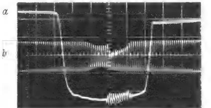
Bild 5. Farbsynchronimpuls auf dem Austastimpuls (a) und Farbtügersignal aus dem Farbtügergenerator am Phasendetektor (b) werden dem Phasendetektor zugeführt
