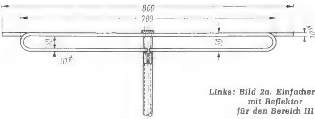
Links: Bild 2a. Einfacher Dipol mit Reflektor für den Bereich III
