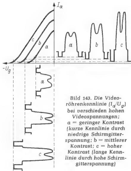
Bild 143. Die Videoröhrenkennlinie ( $I_a/U_g$ ) bei verschiedenen hohen Videospannungen; a = geringer Kontrast (kurze Kennlinie durch niedrige Schirmgitterspannung; b = mittlerer Kontrast; c = hoher Kontrast (lange Kennlinie durch hohe Schirmgitterspannung)
