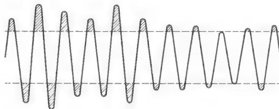
Bild 32.7. Schematische Darstellung der Amplitudenbegrenzung
