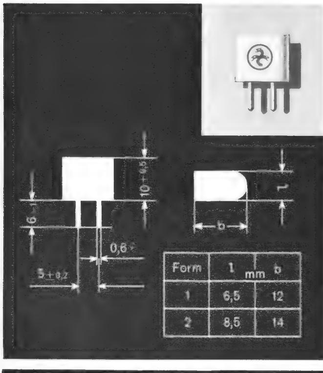
Für gedruckte Schaltungen. Einseitige Drahtanschlüsse, steckbar, Rastermaß 5 mm. Vollisoliert durch Kunststoffgehäuse. Schaltfest durch raue Elektroden. Kontaktsicher durch geschweißte Verbindungsstellen. Flache Gehäuseform ermöglicht enge Packungsdichte und optimale Flächenausnutzung der Printplatte. Gepolte (Pluspol = gerundete Gehäuseseite) und ungepolte (bipolare) Ausführungen. Anwendungsklasse HSF nach DIN 40 040 :
