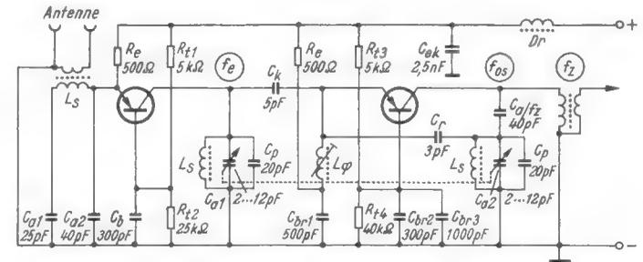
Bild 32.3. UKW-Baustein mit zwei Transistoren in Basisschaltung
