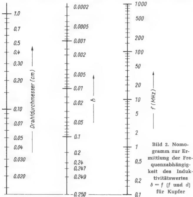
Bild 2. Nomogramm zur Ermittlung der Frequenzabhängigkeit des Induktivitätswertes  $\delta = f(f \text{ und } d)$  für Kupfer
