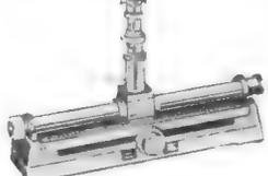
**Dezimeter Meßleitung DML 112. Diese Meßleitung dient zur Bestimmung des Anpaßfaktors und zur Definition der Wellenlänge. Frequenz-Ber.: 500-3500 MHz, auswechselbar. Koaxialleitung für den Wellenwiderstand, 50, 60, 70 Ω, Meßlänge 300 mm. Ablesegenauigkeit 0,02 mm, mit Anzeigeinstrument. Abmessungen: ca. 520 x 320 x 150 mm, Gewicht 6 kg**
