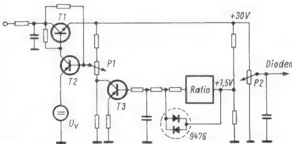
Bild 6. Stabilisierung der Abstimmspannung mit Einspeisung der Scharfabstimmung
